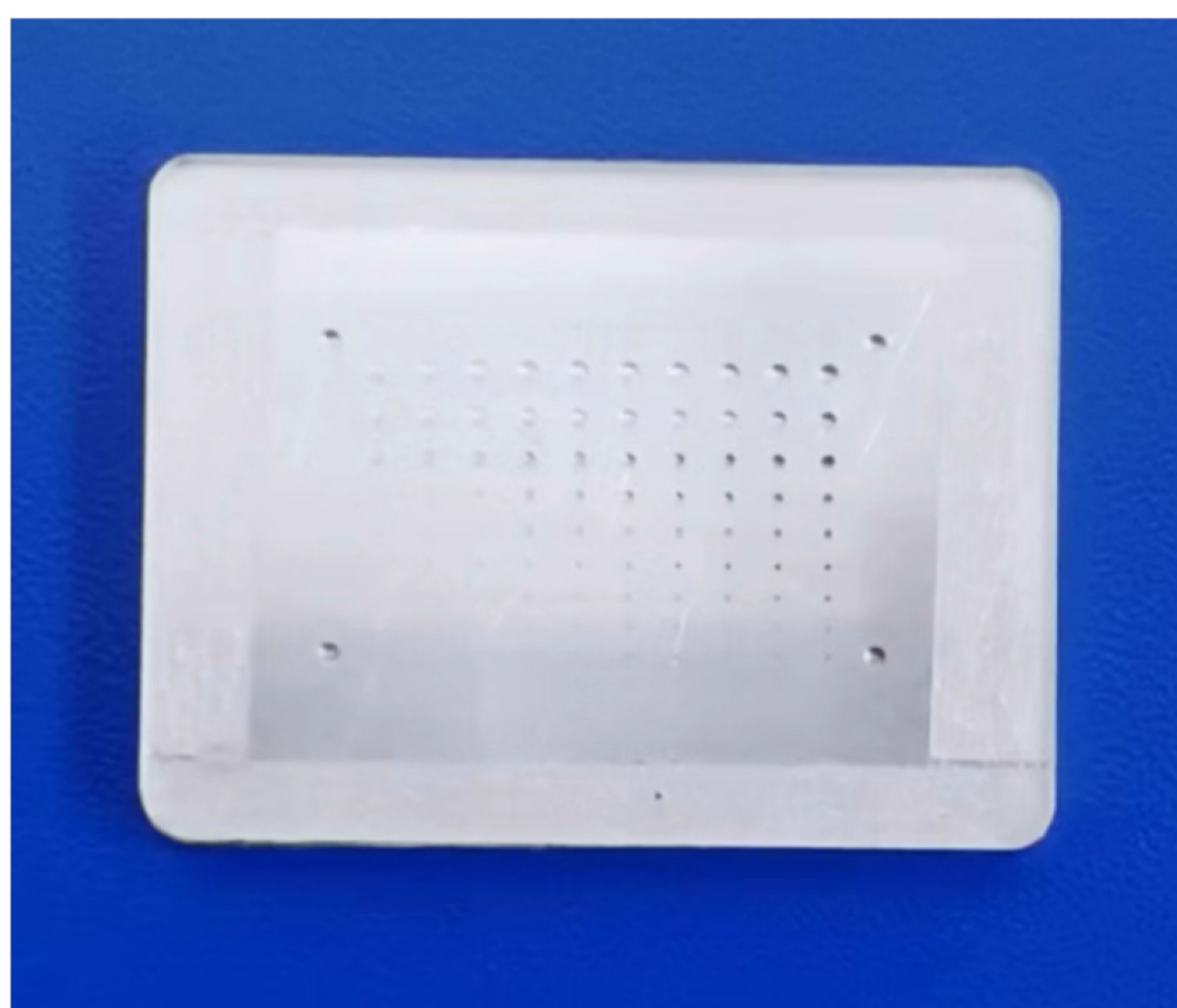
图A.1 牙科低对比度模体实物图
